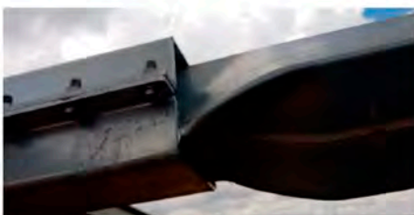
Reproducción mediante modelo de elementos finitos de fallo a torsión en mástil principal ocurrido en campo
